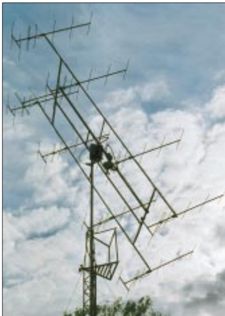
Bild 1: Antennenanlage des Autors mit acht 7-Element-Yagis, hier 20° vertikal angestellt
