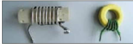
Bild 17: Zwei Spulen annähernd gleicher Induktivität von etwa 1 µH – die Luftspule links, aus 1,5 mm CuAg auf einen Keramikkörper gewickelt, hat bei 17 MHz eine Güte von 175; die rechte, mit CuLBw auf einen Amidonkern T68-6 gewickelt, bringt es auf 240 ...
