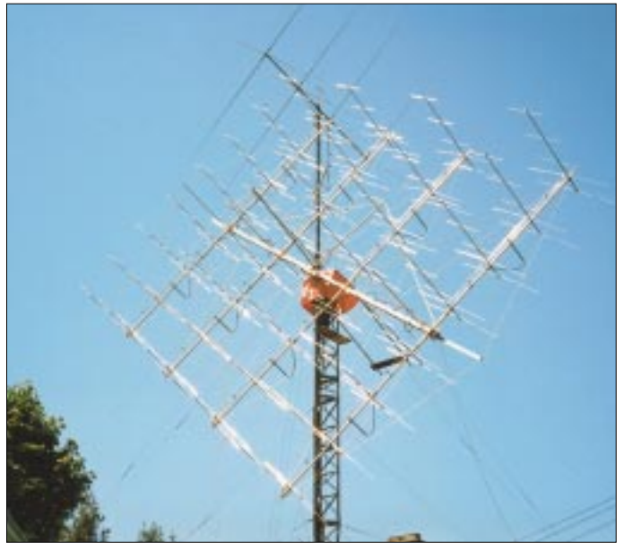
Bild 2: Diese aus 32 kurzen Yagis bestehende Antennengruppe von VE7BQH erlaubt eine zusätzliche Polarisationsdrehung, hier im Bild sind es 40°.
